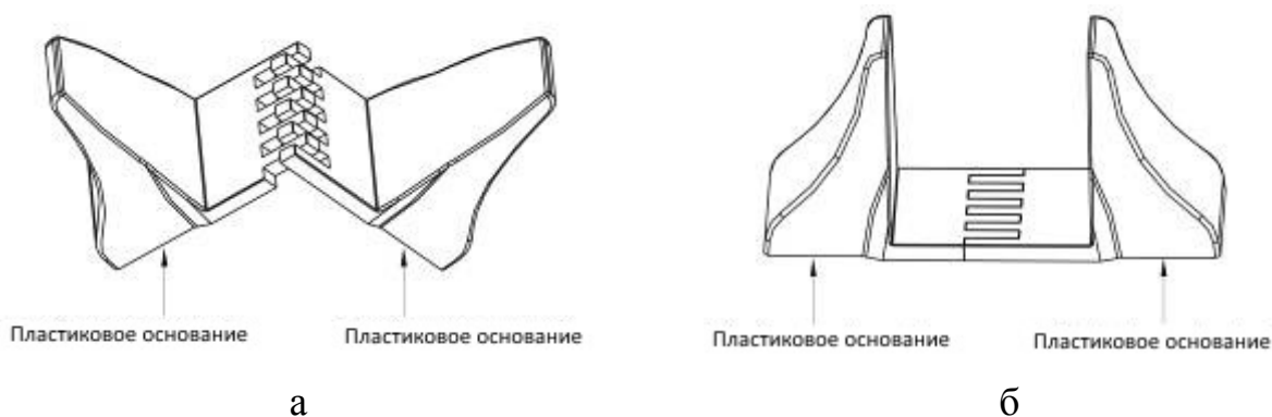
Рисунок 2.5 – Порядок сборки стойки для напольной установки ИБП
