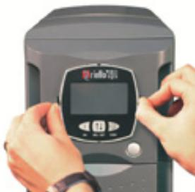
2. Повернуть панель управления против часовой стрелки и вновь закрепить ее
