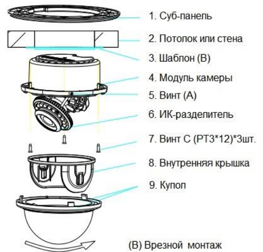
(В) Врезной монтаж
